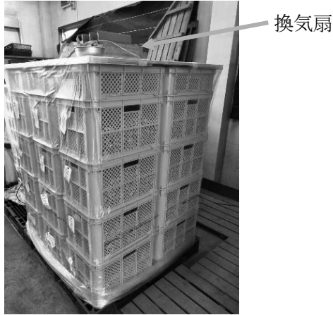
写真1 簡易乾燥システム
