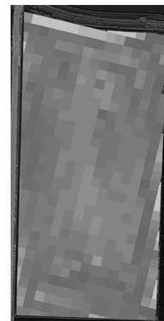
第3図 自動運転湛水直播の作業軌跡（途中まで、上）と収量メッシュマップ（下） 上：外周のティーチングに引き続いて自動走行を実施中 下：推定収量が高いほど、5mメッシュが濃く表示される
